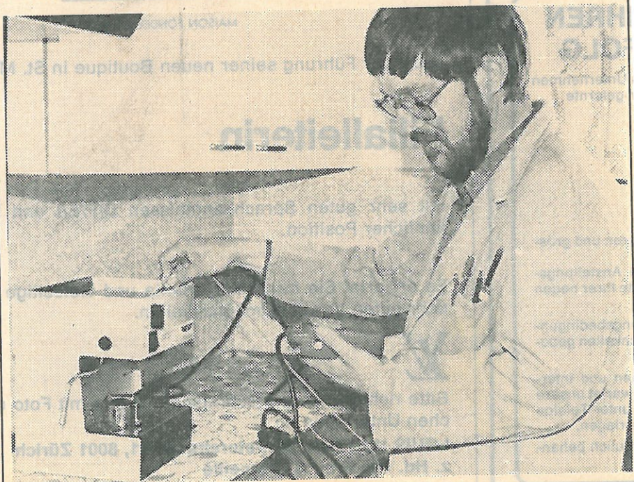
Alfred Friedrich ist Installationskontrolleur des EWZ in Sils i.D. Er kontrolliert alle 20 Jahre die Hausinstallationen und er misst die Haushaltgeräte aus und kontrolliert, ob die Gehäuse Kriechströme aufnehmen, die schliesslich zu Bränden oder Unfällen führen können. (Bild Barandun)
